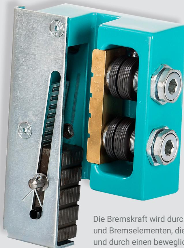
Die Bremskraft wird durch eine Kombination von Tellerfedern und Brems-elementen, die immer paarweise angeordnet sind und durch einen beweglichen Auslösekeil.
