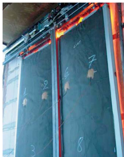
Fot. 4: Dwupanelowe centralnie otwierane drzwi Wittur Hydra podczas badań mających na celu uzyskanie certyfikacji EN 81-58 E120.
