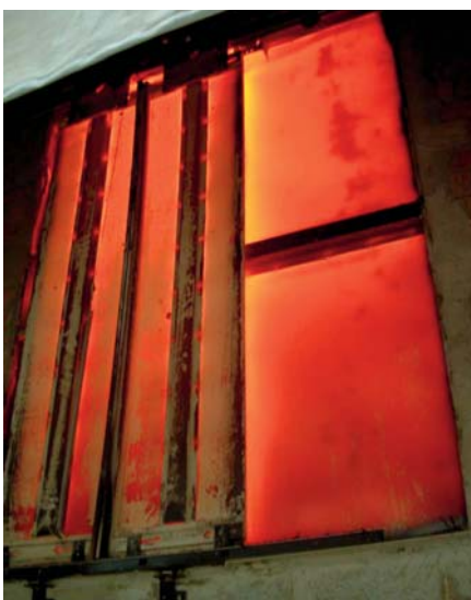
Fot. 3: Dwupanelowe centralnie otwierane drzwi Wittur Augusta podczas badań mających na celu uzyskanie certyfikacji EN 81-58 E120.
