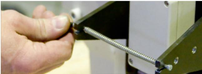
3. Anschließend Gegenseite einhängen. Hierzu ist etwas Kraft erforderlich, da eine Vorspannung notwendig ist. Hinweis: Bowdenzüge sollten dabei gerade verlegt und nicht „aufgewickelt“ sein.
