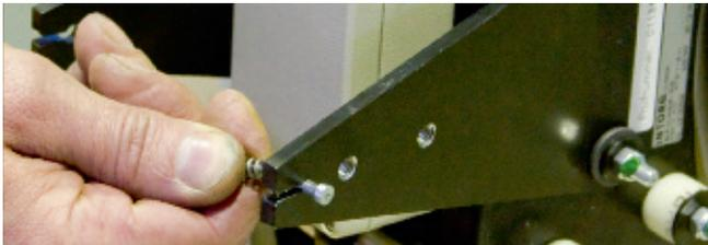
2. Bowdenzüge an der Maschine zunächst am Ende einhängen.
