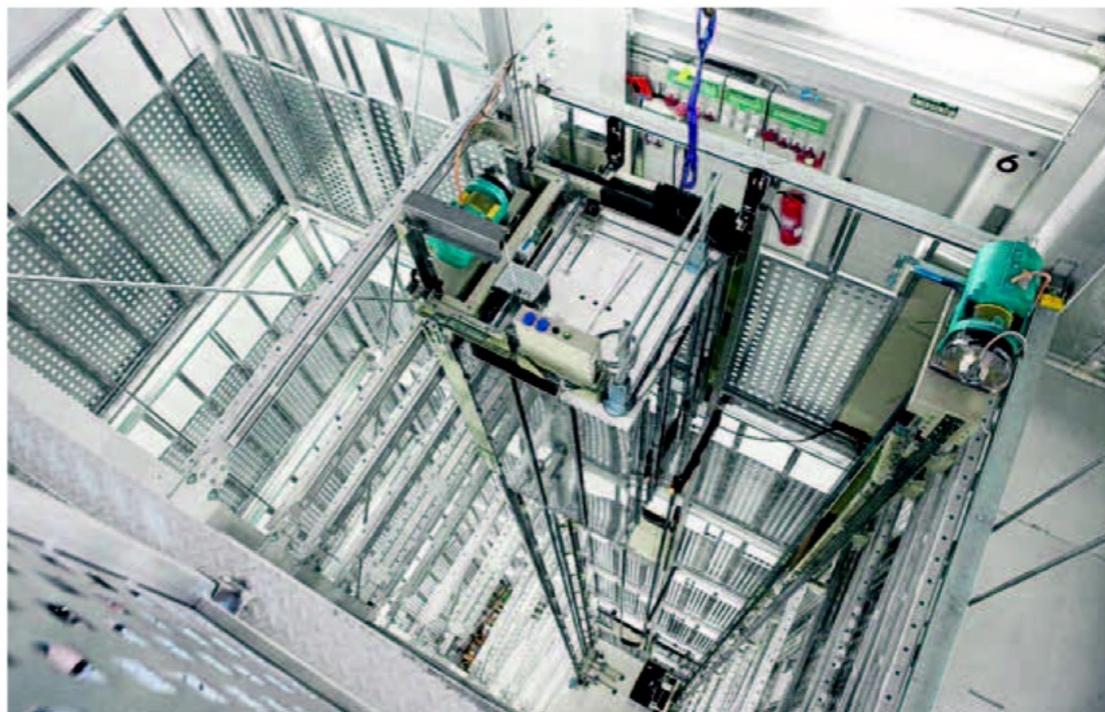
Interior de la torre de pruebas de la planta zaragozana de Wittur, con dos ascensores ya instalados. ARÁNZAZU NAVARRO
