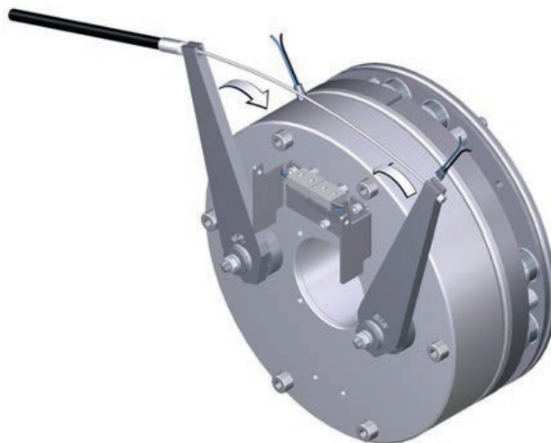
Abb. 25: Betätigungsrichtung des Hebels
