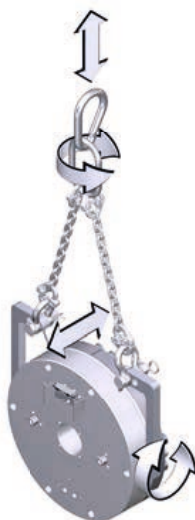
Abb. 8: Hebevorrichtung zum Einhängen in ein Hebezeug
