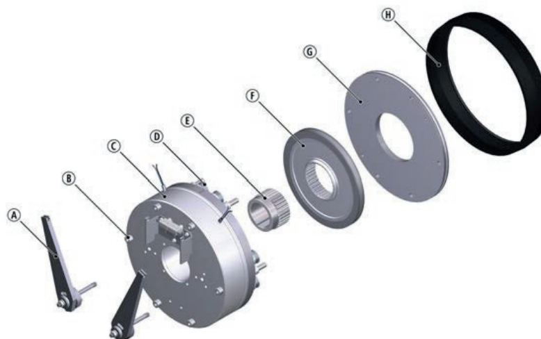
Abb. 26: Federkraftbremse 464-□□R
