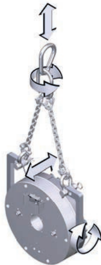
Abb. 8: Hebevorrichtung zum Einhängen in ein Hebezeug
