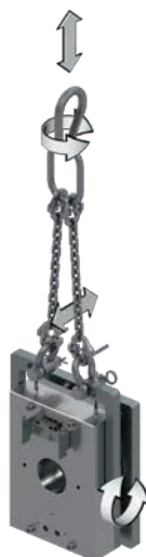
Abb. 8: Hebevorrichtung zum Einhängen in ein Hebezeug
