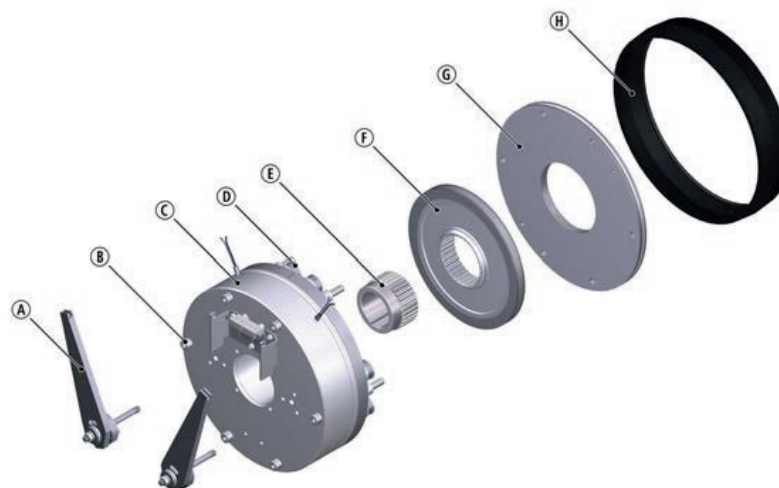
Abb. 26: Federkraftbremse 464-□□R
